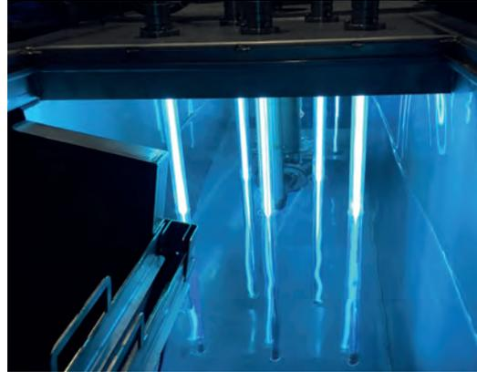
*disinfezione dell'acqua con sterilAir® AQT nel serbatoio CIP e nel lavaggio dell'aria.*
