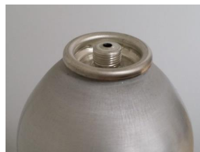
Attacco TEST CAN 12 L.: filetto maschio 7/16” – 28 NS/2
